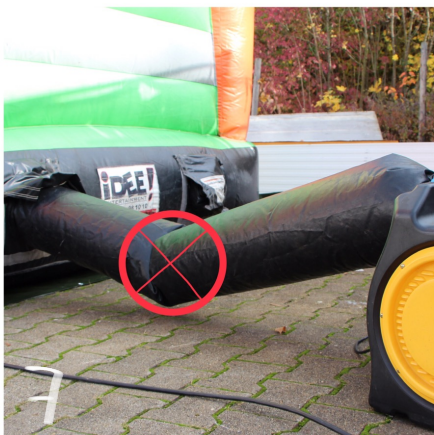
7 Luftschnlauch darf nicht geknickt/verdreht sein
