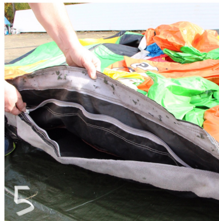
5 Falls vorhanden, Reisverschlüsse/Öffnungen rundherum schließen
