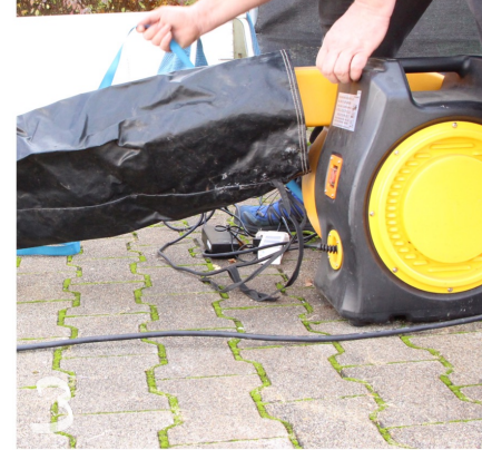
3 Luftschnlauch über den Gebläsestutzen ziehen
